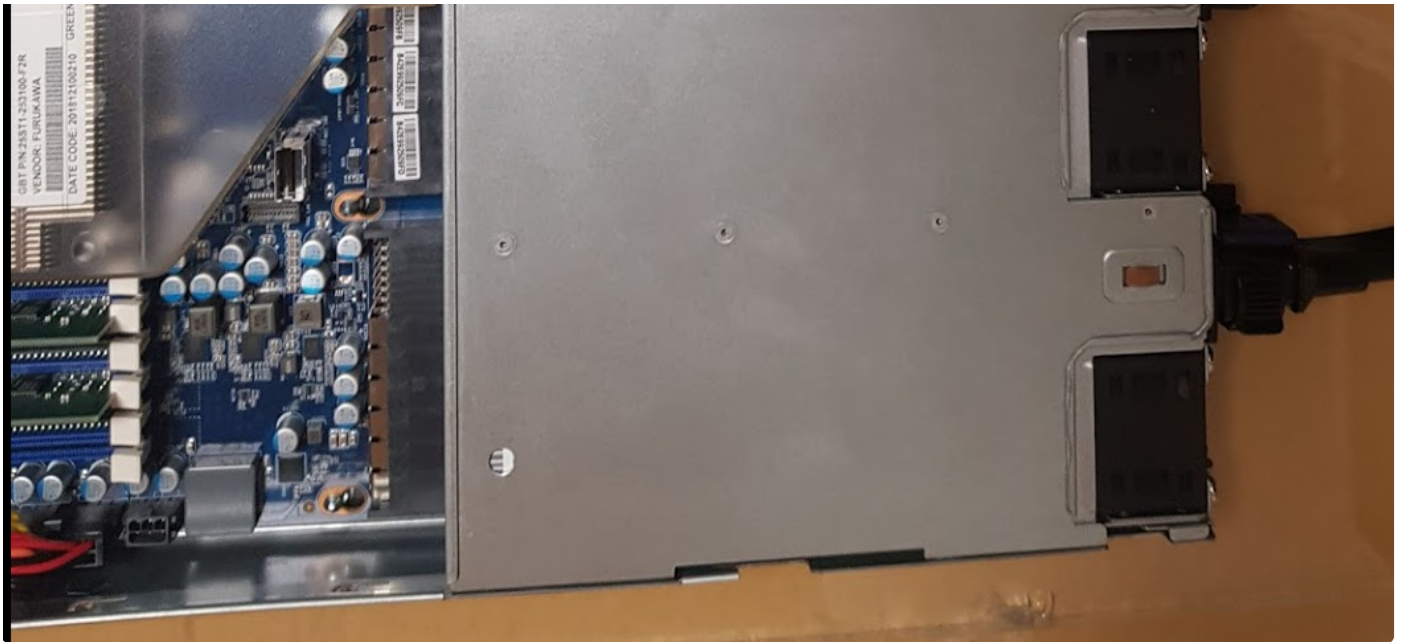
FMADIO20G Gen3 PCIe slot layout
